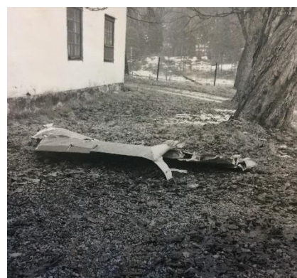
Bild 8. Stabilisatorn, dvs delen mellan stjärtbommarna, hittades på gårdsplanen till Ekhammars gård strax norr om kyrkan.
